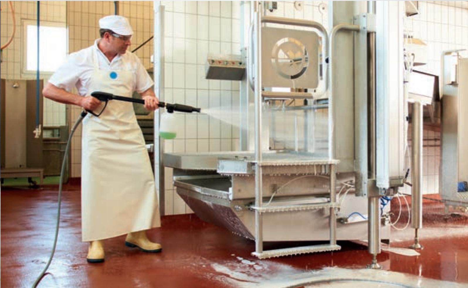
Abb. Sicherheits-Abschalt pistole mit Schauminjektor, Seite 75
