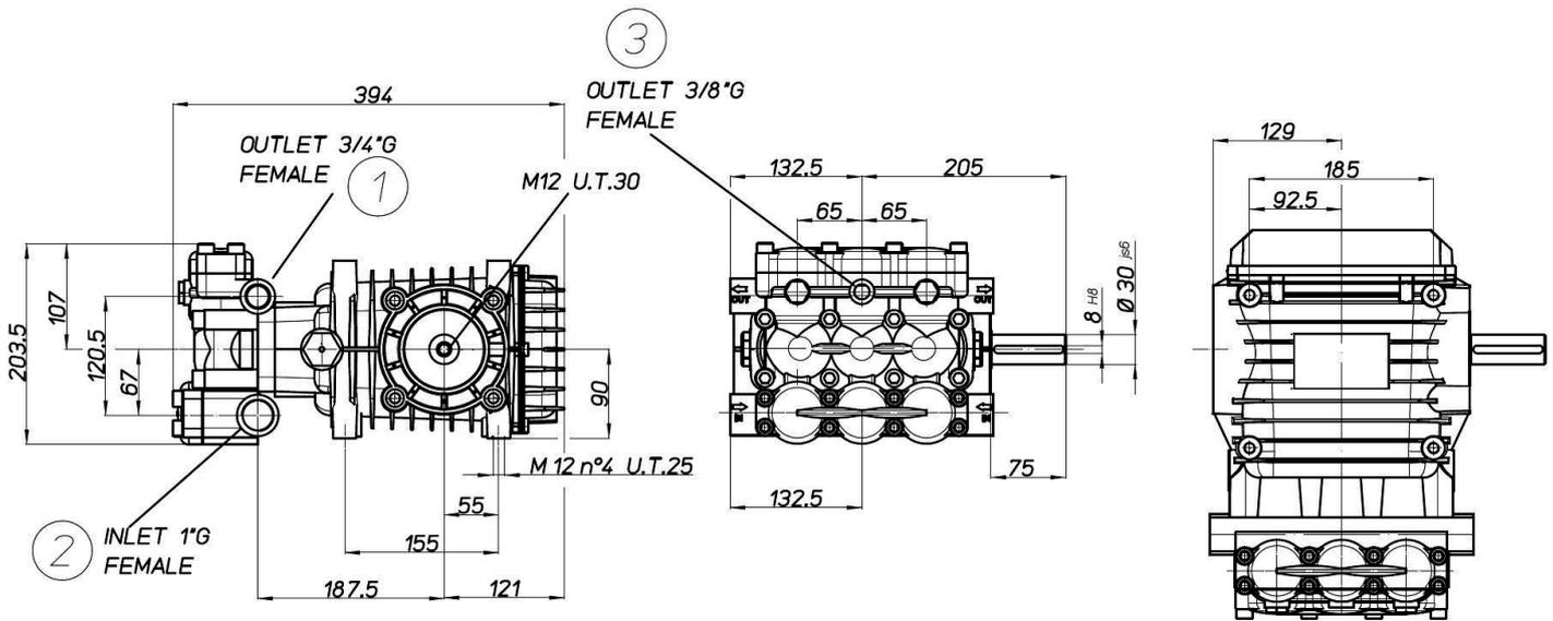
HYDRAULIC MOTOR FLANGE › BRIDA MOTOR HIDRÁULICO › FLANSCH HYDRAULIKMOTOR › FLANGIA MOTORE IDRAULICO › BRIDE MOTEUR HYDRAULIQUE
