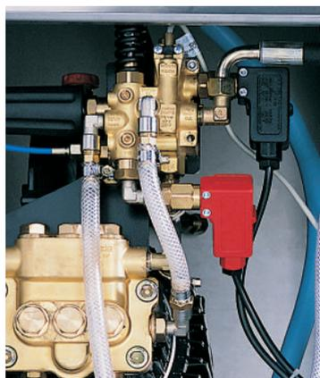
Die von Kränzle entwickelte neuartige Sicherheitsarmatur umfaßt das Druckregelventil zum stufenlosen Regeln von Wassermenge und -druck und ermöglicht den drucklosen Bypass-Betrieb. Weiterhin schützt ein Sicherheitsventil die Maschine vor unzulässig hohem Überdruck. Der integrierte Strömungswächter schaltet bei Wassermangel den Ölbrenner ab und verhindert so ein Überhitzen der Heizkammer.
